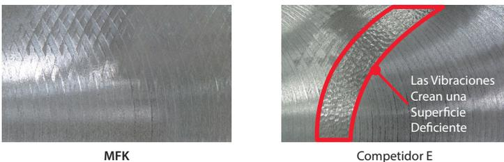
Condiciones de Corte :  $V_c=180\text{m/min}$ ,  $f_z=0.3\text{mm/t}$ ,  $ap_{xae}=3 \times 78\text{mm}$ , Sin Refr. Pieza de Trabajo : FCD600
