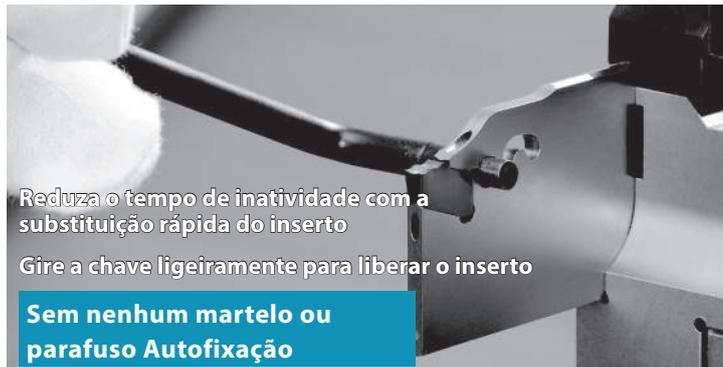
Reduza o tempo de inatividade com a substituição rápida do inserto
