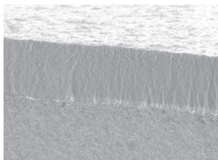
Seção transversal do revestimento de diamante
