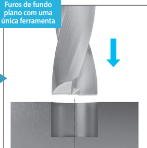
Acabamento de fundo plano após furação
