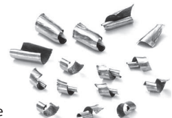
Exemplo de cavacos
