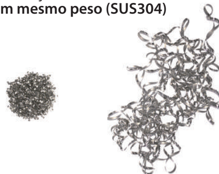
Cavacos gerados por corte por vibração em baixa frequência
