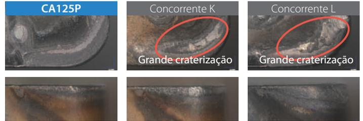
Condições de corte :  $V_c = 300$  m/min,  $a_p = 1.5$  mm,  $f = 0.3$  mm/rev, Com refrig. Material: SCM435
