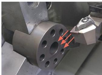
Condiciones de corte :  $V_c = 150 \text{ m/min}$ ,  $f = 0.2 \text{ mm/rev}$ ,  $a_p = 0.2 \text{ mm}$  Sin refr. SCM415®
