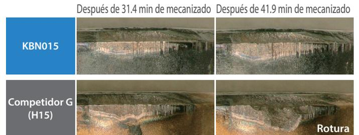
Evaluación del Mecanizado de Alta Velocidad ( $V_c=200\text{m/min}$ )
