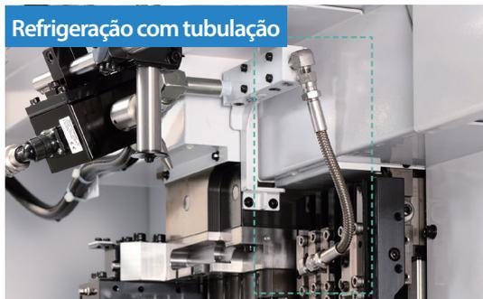
Compatível com refrigeração interna em qualquer
