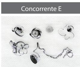
Condições de corte:  $V_c = 250$  m/min,  $a_p = 2.0$  mm, Com refrig. Material: A6061
