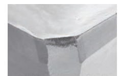
Concorrente F Após Usinagem de 11 m
