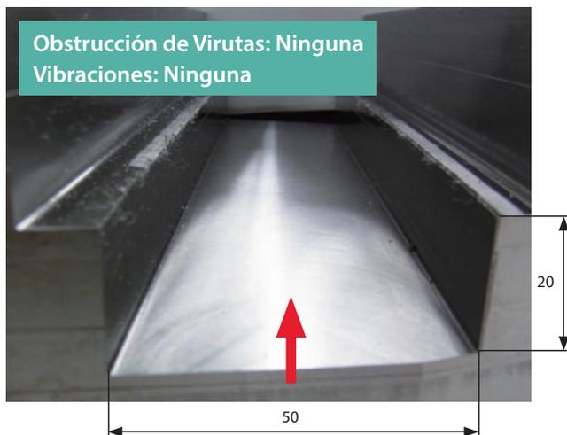
Condiciones de Corte:  $V_c = 40$  m/min.,  $ap \times ae = 20 \times 50$  mm (Ranurado),  $f_z = 0,08$  mm/t  $\phi 50$  (5 Flautas), Con Refr. (Líquido refrigerante externo e interno) Pieza de Trabajo: Ti-6Al-4V Máquina: BT50
