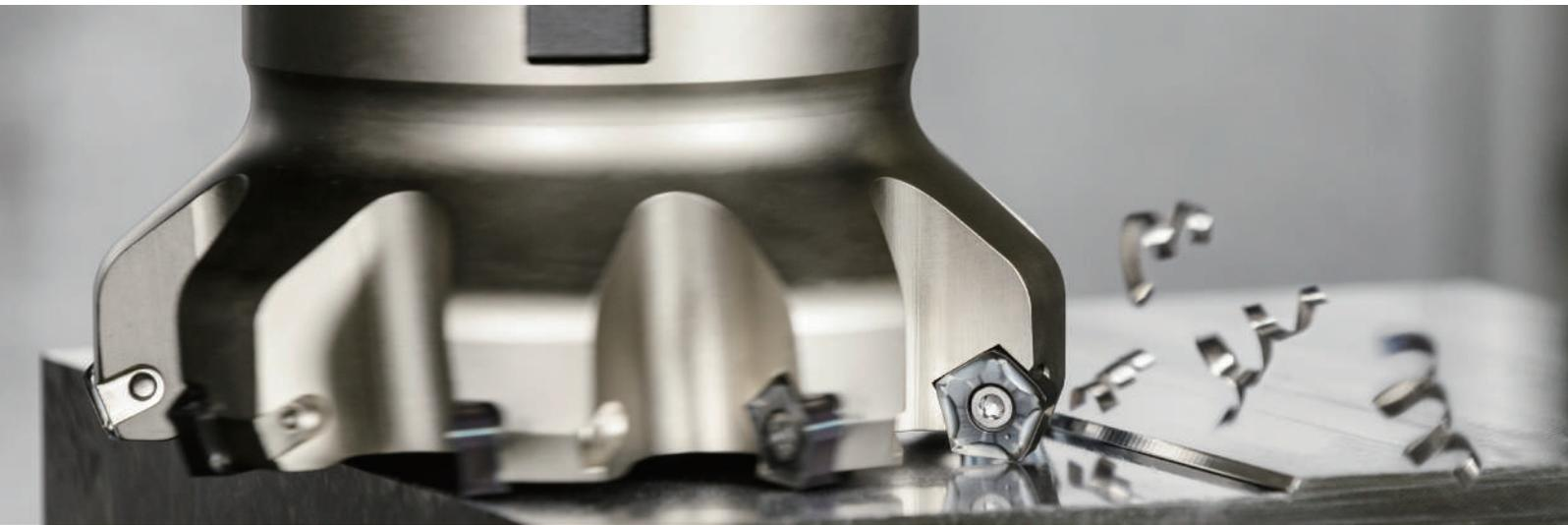
**Insertos Econômicos com 10 Arestas de Corte. Reduz a Vibração com Design de Baixo Esforço de Corte**
