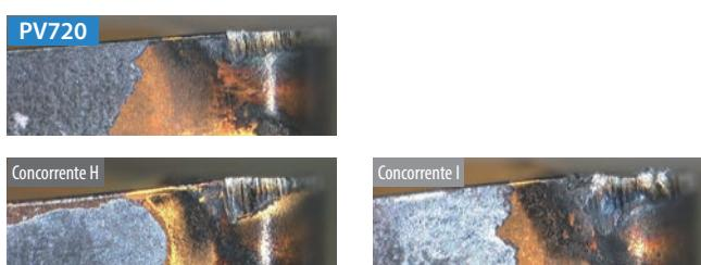
Comparação de Resistência ao Desgaste (Avaliação Interna)
