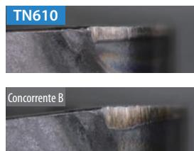
Condições de Corte: Vc = 300 m/min, ap = 1.0 mm, f = 0.2 mm/rev,
