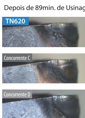
Condições de corte: Vc = 200 m/min, f = 0.2 mm/rev, ap = 1.0 mm
